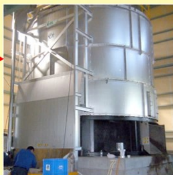
◆鹿児島リサイクルセンターに設置してある大型コンポスト (容量:約85m 3 /機械の高さ:7m/直径:8m)
